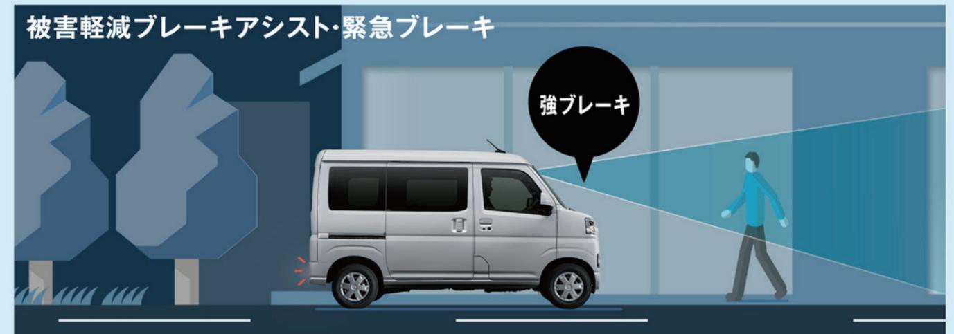
事前ブレーキが作動している時にドライバーがブレーキペダルを踏み込むと、ブレーキアシストが作動し、ブレーキ制動力を高め、衝突が避けられないとシステムが判断した場合、強いブレーキで減速。衝突の回避や、被害の軽減をサポートします。
